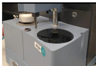
Figura 2.3. Fotografia del calorimetro Q1000 (TA Instruments) durante il posizionamento del campione all'interno della fornace, insieme al riferimento. Accanto alla fornace è visibile la camera nera contenente un auto-sampler a 50 posizioni, utilizzato per la gestione automatica dei campioni. L'analisi termica è invece eseguita dalla fornace interna del sistema DSC.
