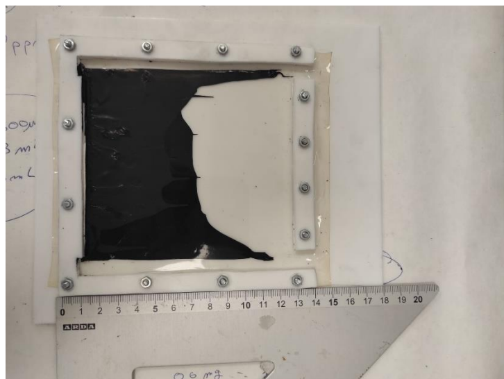
Figura 211: Elemento di fissaggio Nafion ® prodotto dal gruppo CNR-ITAE
