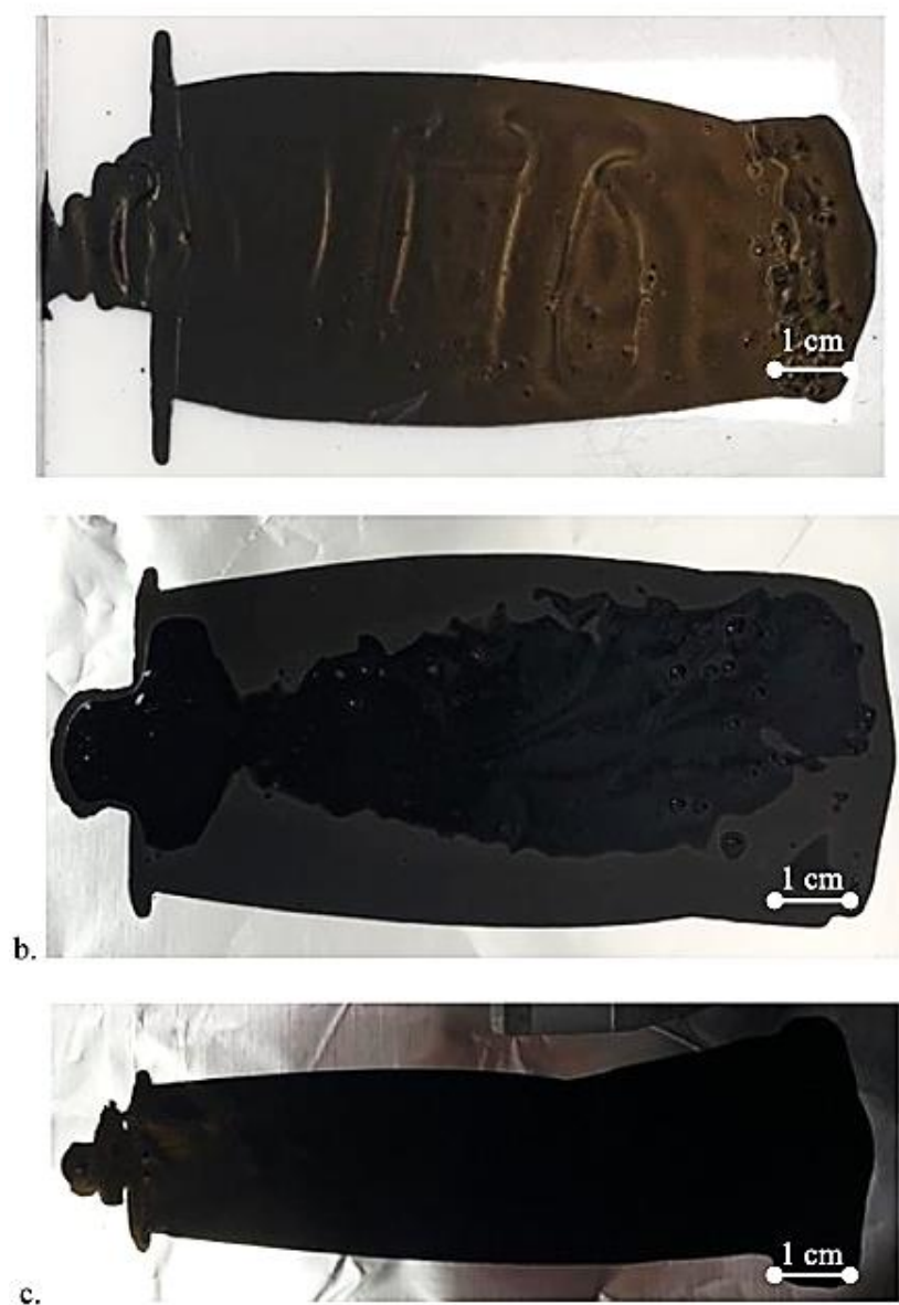
Figura 210: Deposizione di inchiostro con cartucce dotate di lame di diversa larghezza: a) 1,5 mm; b) 1,0 mm; c) 0,5 mm.
