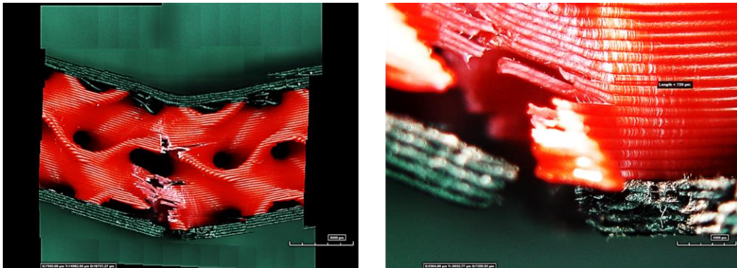
Figura 63 : Immagini al microscopio ottico delle modalità di frattura dei provini a struttura sandwich in PLA rinforzato con fibra di carbonio.
