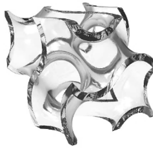
Figura 32: Struttura di cella unitaria di geometria Gyroid.
