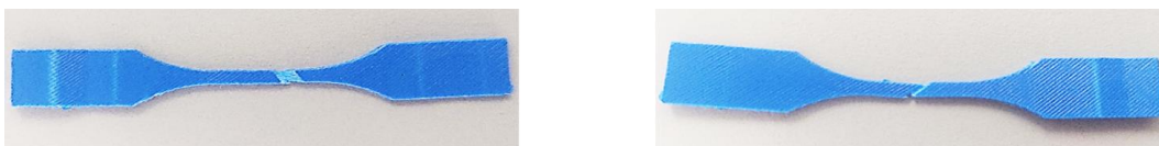
Figura 72 : Modalità di frattura dei provini in PLA sottoposti a prova di trazione.
