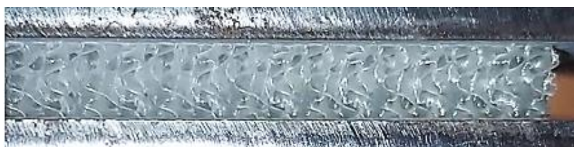
Figura 137: Fotografia della prova di compressione eseguita su provino TPMS di tipo I-WP, realizzato in resina High Temp.
