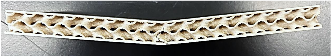
Figura 88: Provino stampato a 200 °C con layer 0.24 mm.
