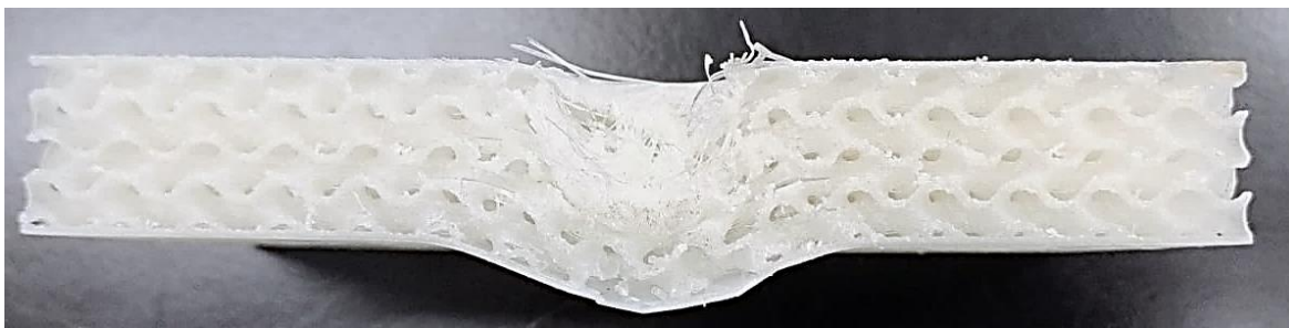
Figura 24: Foto del provino non densificato (piano di sezione).
