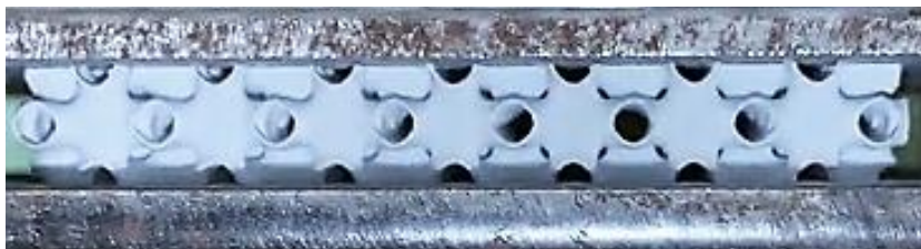
Figura 135: Fotografia della prova di compressione eseguita su provino TPMS di tipo Fischer–Koch S, realizzato in resina Rigid 10K.
