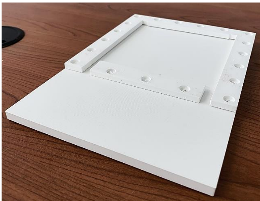
Figura 216: Elemento di fissaggio Nafion prodotto in additive manufacturing
