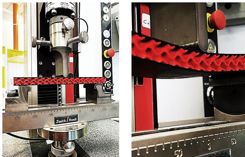
Figura 59: Configurazione dell'apparato sperimentale per la prova di flessione.
