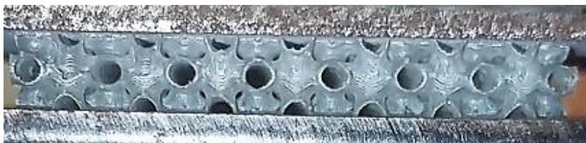
Figura 136: Fotografia della prova di compressione eseguita su provino TPMS di tipo Fischer–Koch S, realizzato in resina High Temp.
