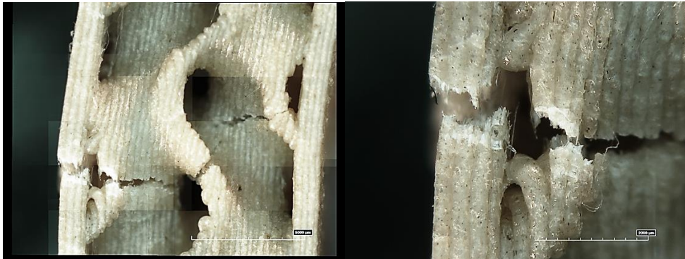
Figura 99: Dettaglio al microscopio del punto di frattura del provino stampato a 220 °C con layer 0.28 mm.
