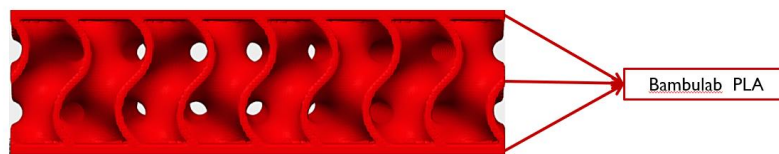
Figura 57: Vista frontale del provino in PLA con configurazione a struttura sandwich.
