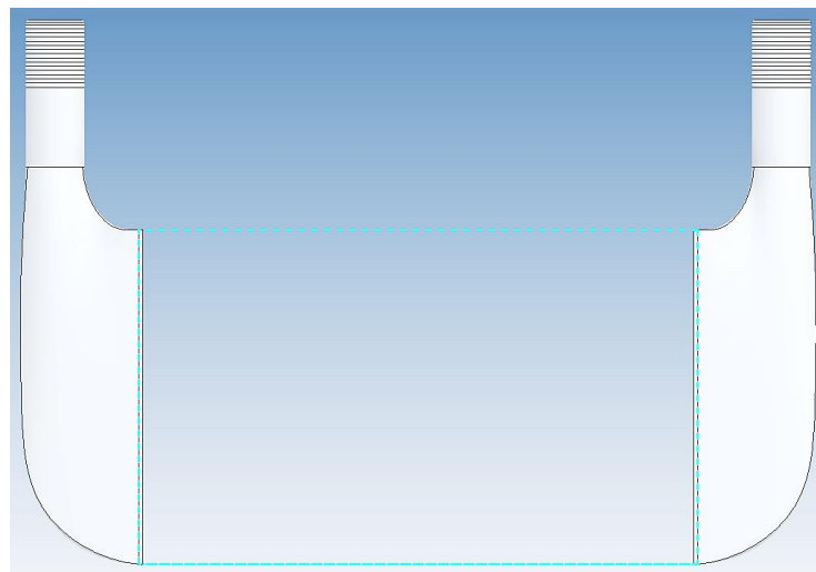
Figura 159: Modello tridimensionale dei condotti ridisegnati dello scambiatore di calore, rappresentato in vista frontale.
