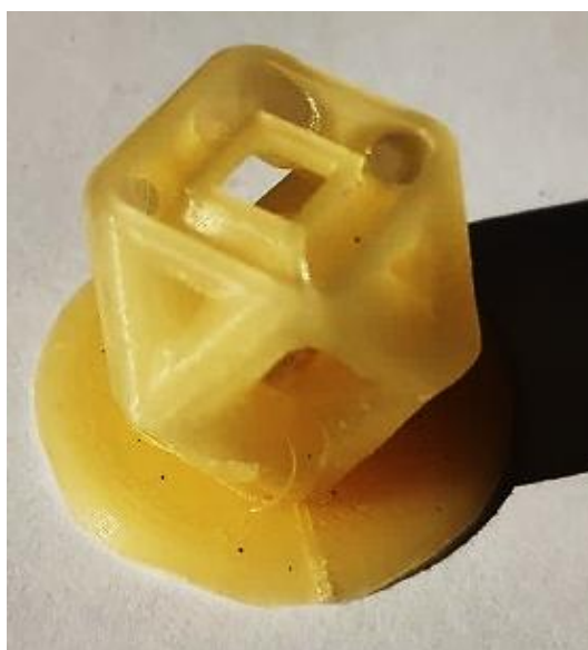
Figura 185: Stampo singola cella ottimizzato.
