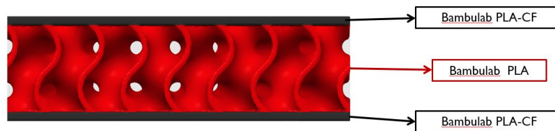
Figura 58: Vista frontale del provino in PLA con configurazione a struttura sandwich.
