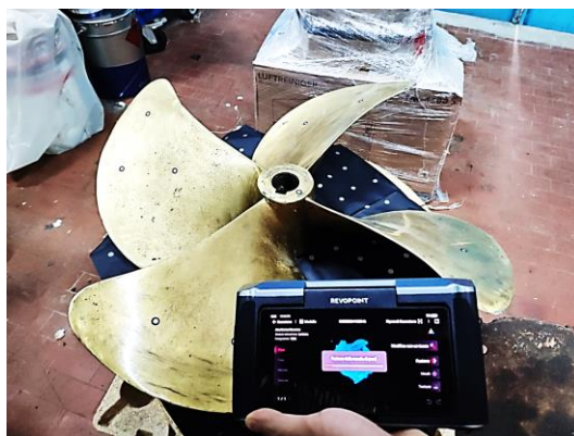
Figura 161: Dettaglio del processo di acquisizione dell'elica.
