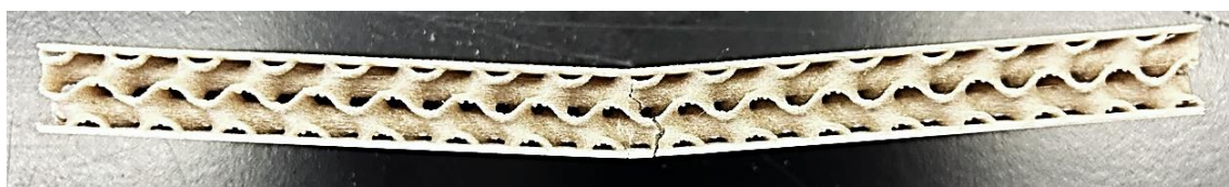
Figura 92: Provino stampato a 220 °C con layer 0.16 mm.
