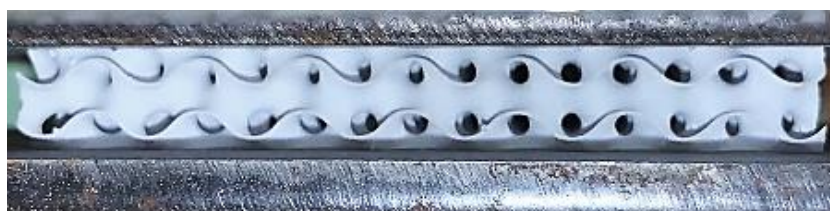
Figura 134: Fotografia della prova di compressione su provino TPMS di tipo Giroide, realizzato in resina Rigid 10K.
