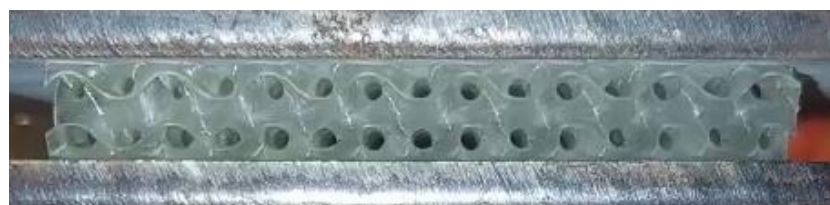
Figura 138: Fotografia della prova di compressione eseguita su provino TPMS di tipo Giroide, realizzato in resina High Temp.
