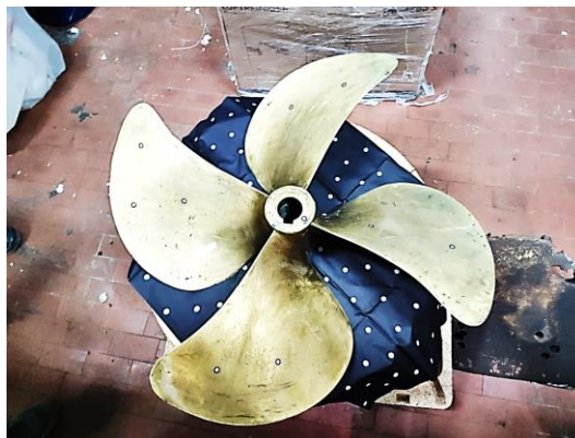
Figura 160: Elica smontata con marker applicati.
