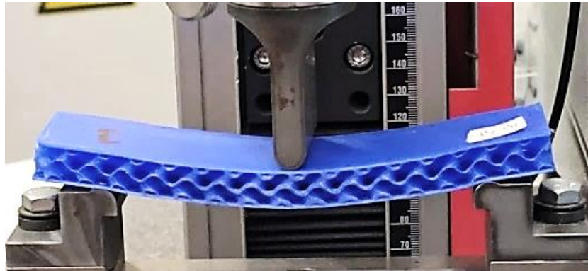
Figura 45: Configurazione della prova di flessione a tre punti.
