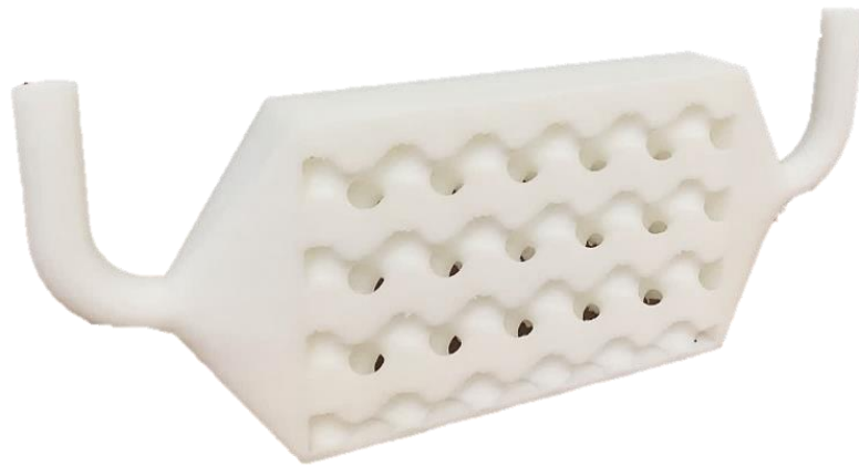
Figura 150: Prototipo di scambiatore di calore aria–acqua con geometria TPMS di tipo Giroide, realizzato mediante stampa 3D in materiale ABS.
