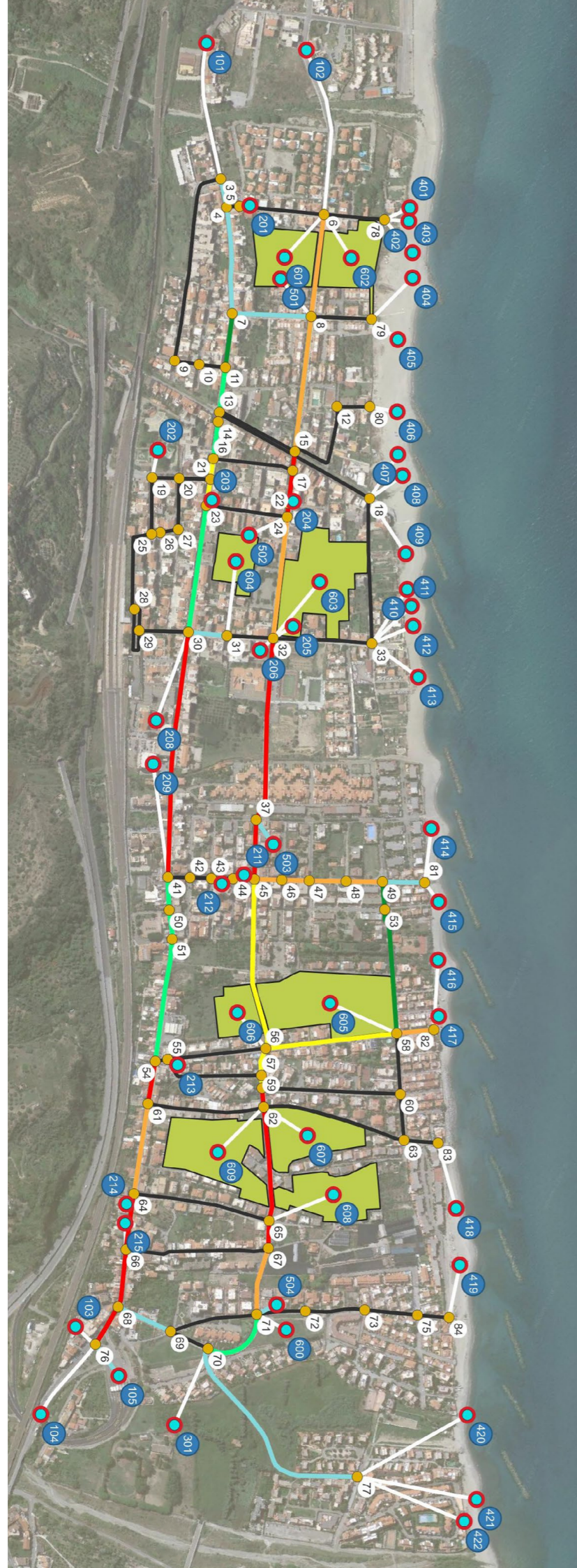
Fig. 39 Aree di intervento, grafo stradale e gradi di saturazione per l'alternativa n. 2
