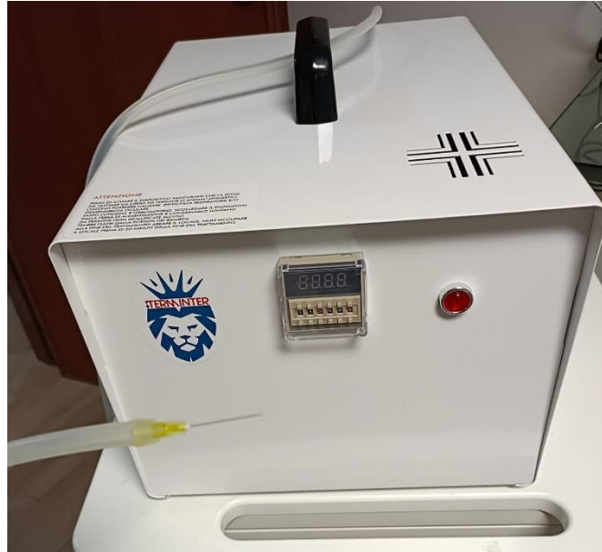
Figura 47. Generatore di ozono collegato al tubo di diffusione con un puntale simile ad un ago di minime dimensioni.
