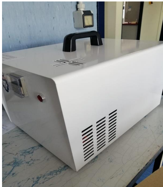
Figura 42. Generatore di ozono (CUBO) utilizzato per l'esposizione alla miscela gassosa O_3/O_2 dei campioni di allineatori.
