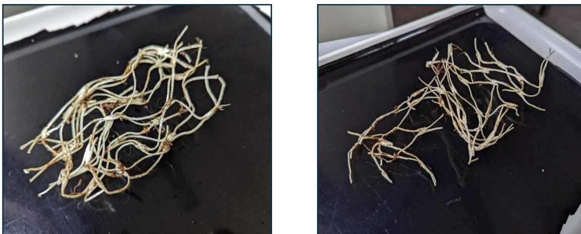
Figura 29. Segni di deterioramento delle reste in Mater-Bi®
