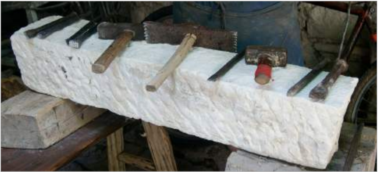
fig. 136 – Gli strumenti dello scalpello Bruno Perini. Da sinistra: scalpello, gradine, scalpello a testa bocciardata, bocciarda, martellina a lama dentata, scalpello, mazzetta, punta (subbia), scalpello a lama larga.
