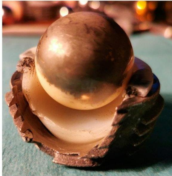
*Figura 30 Un esempio della rettifica a tazza acetabolare e del suo inserto UHMWPE dalla testa in ceramica Al<sub>2</sub>O<sub>3</sub> durante decenni di camminata.*
