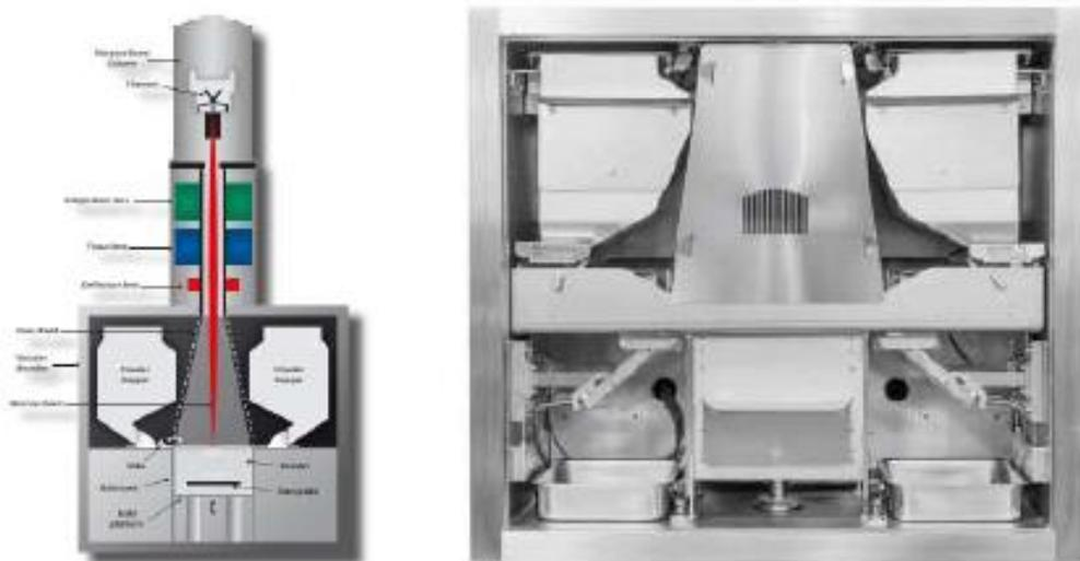
Figura 19 Macchina Arcam Q10, con indicazione di tutte le parti principali componenti la macchina come ad esempio il sistema di lenti, la camera di vuoto, fascio elettronico, piano di stampa.
