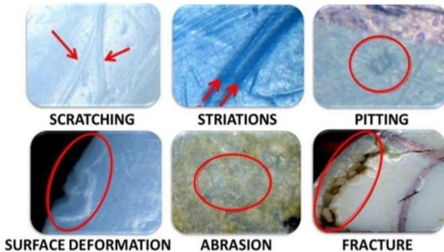
Figura 28 Tipologie di usura polimerica
