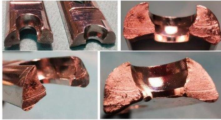
Figura 3 Aree di fratture fragili e a fatica in quel sito di rottura.
