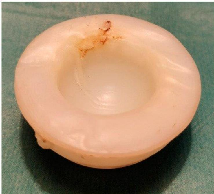
*Figura 5 Scorrimento e usura che portano alla deformazione dell'inserto UHMWPE acetabolare.*
