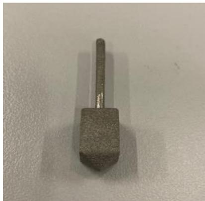
Figura 34 Punta realizzata in EBM
