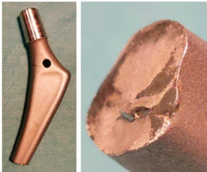
*Figura 31 Rottura del fusto dello stelo della protesi d'anca e macrofotografia della superficie di frattura*
