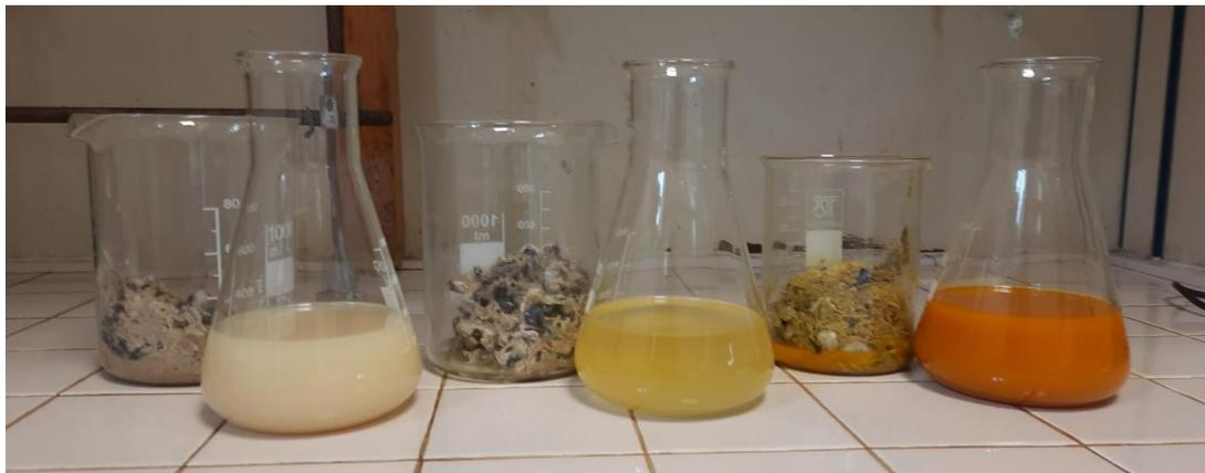
*Figura 34 Estrazione dalle teste con tre diversi solventi (etanolo, d-Limonene, olio essenziale): Fase solida e fase liquida*
