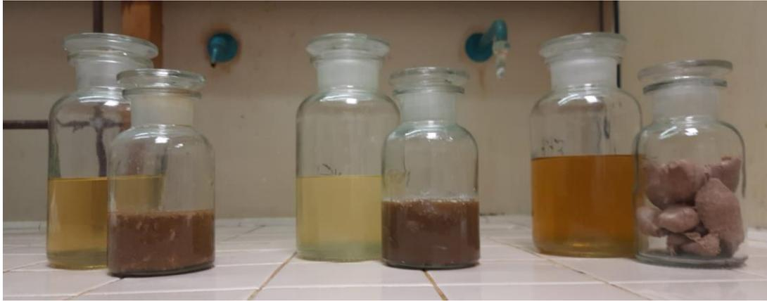
*Figura 33 Estrazione dalle interiora con tre diversi solventi (d-Limonene, 2-Meox, etanolo): Fase solida e fase liquida*
