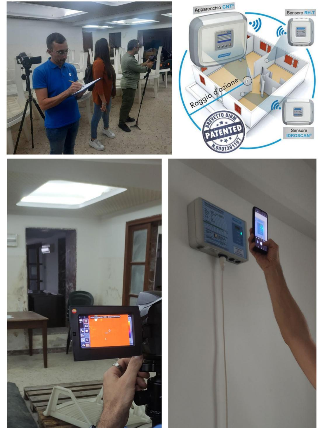
Figura 13 - In alto: sistema CNT® Domodry®; in basso: scatto di un sopralluogo, durante il quale è stato rilevato, dai tecnici INBAR e da un tecnico Domodry®, lo stato di recessione della risalita di capillarità dell'acqua a distanza di 5 anni del posizionamento della tecnologia CNT - apps
