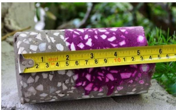
**Figura 2.10** - Misura della profondità di carbonatazione mediante prova alla fenolftaleina.
