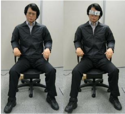
Figura 7: Geminoid HI-1, progettato all'Università di Osaka da Hiroshi Ishiguro sulle fattezze di se stesso. Riproduce la sua voce e i suoi movimenti del capo ed è controllato da remoto.
