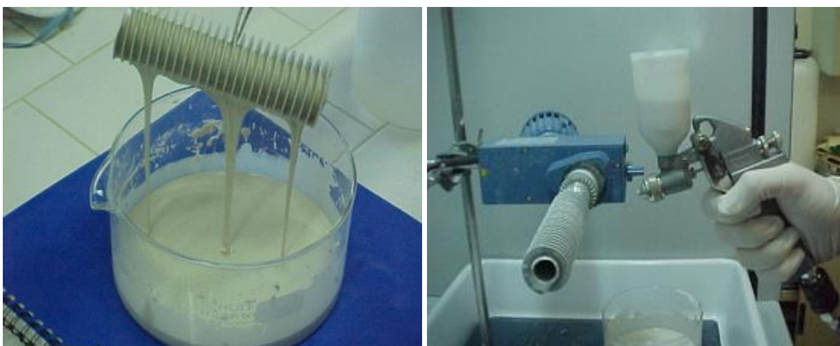
Figura 24. Esempi di esecuzione dei processi di “Dip coating” (a) e “Spray Coating” (b).
