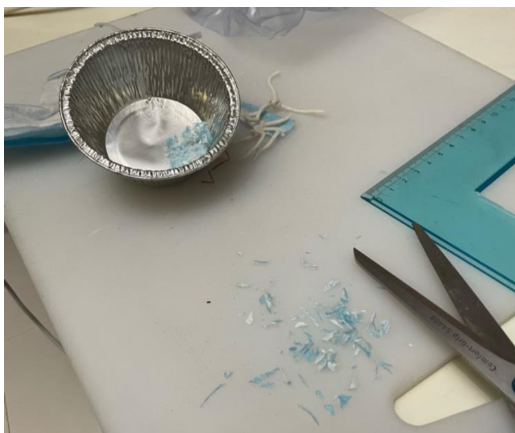
Figura 8. Fasi di frammentazione di una mascherina in laboratorio.
