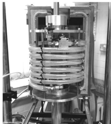
Fig. 2.6: schematizzazione inerter a fluido elicoidale da Smith M.C., 2020 e prototipo sviluppato da Domenico et al.
