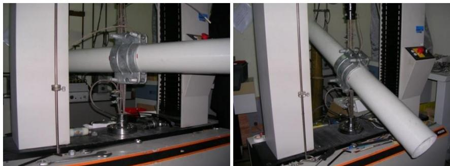
Figura 211 - Prova di trazione sui collari per pali in vtr
