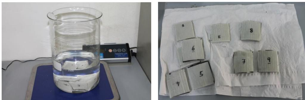
Figura 119 - Prova di assorbimento d’acqua
