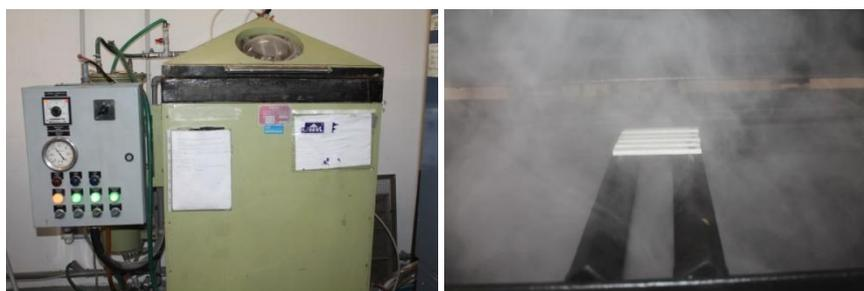
**Figura 82 - Prova in nebbia salina**
