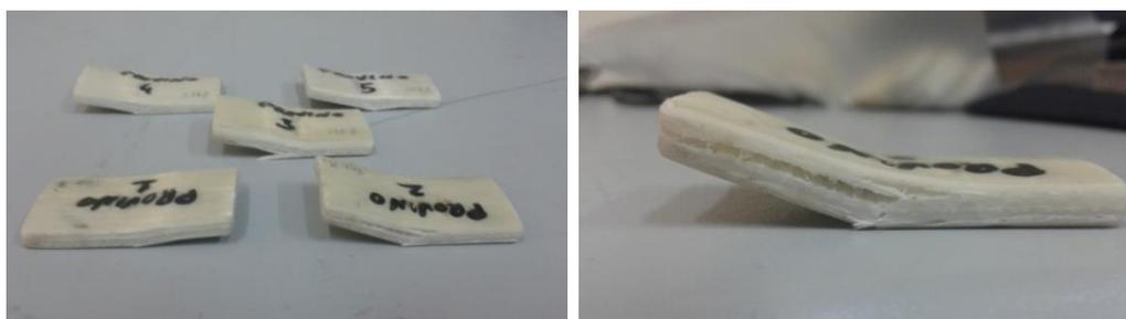
Figura 115 - Taglio interlaminare: provini sezione 8m
