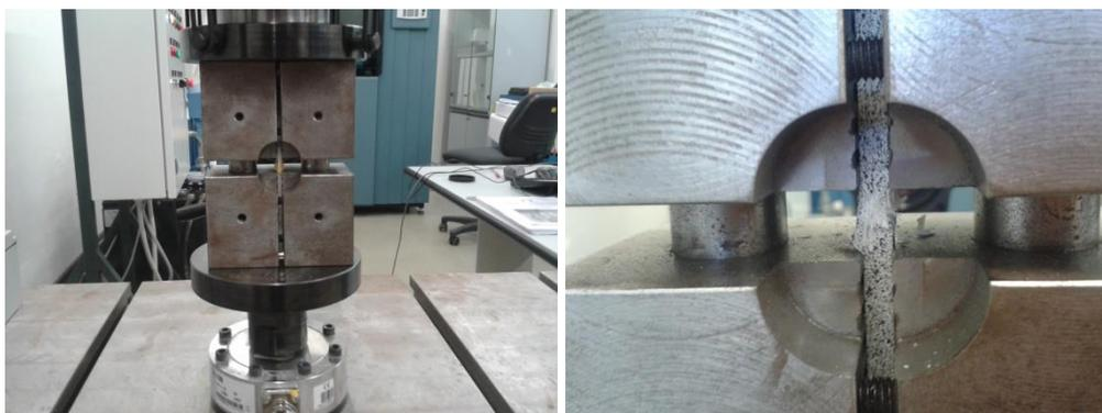
Figura 91 - Attrezzatura CLC per i test di compressione
