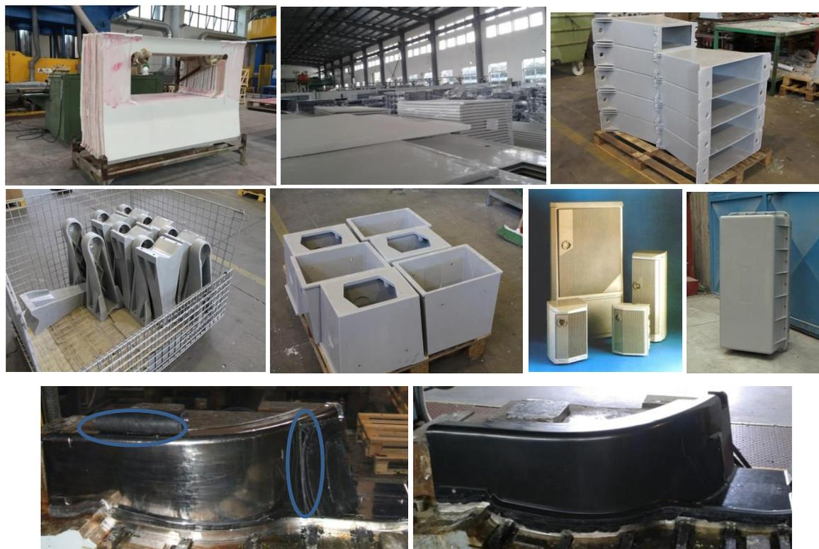
Figura 6 – Prodotti realizzati con la tecnologia dello stampaggio a compressione
