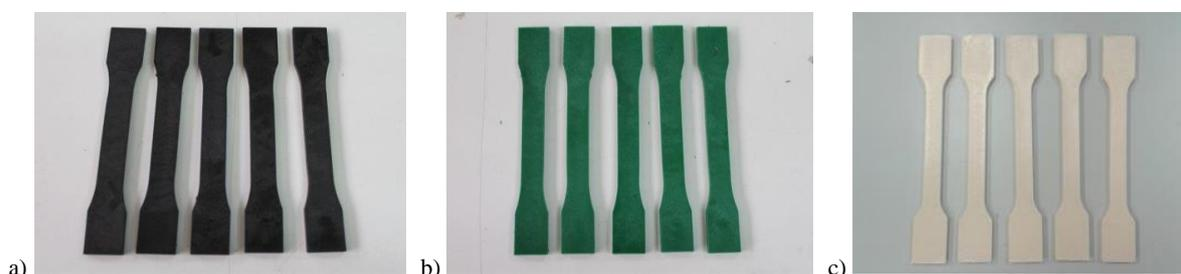
**Figura 44 – Provini termoplastici: a) Noryl SE1GFN2; b) Lexan 3412R; c) Lexan 500R**
