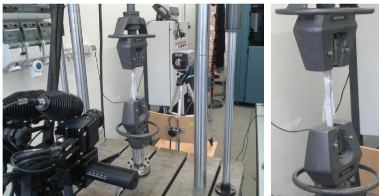
Figura 61 – Prova di trazione centrifugati: campione in prova
