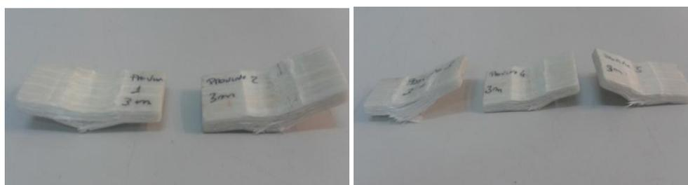
Figura 111 - Taglio interlaminare: provini sezione 3 m
