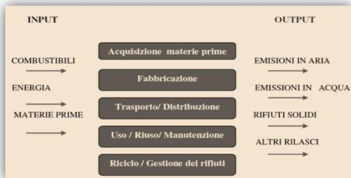
Figura 215 - Analisi di inventario attraverso i principali processi che appartengono al generico sistema indagato
