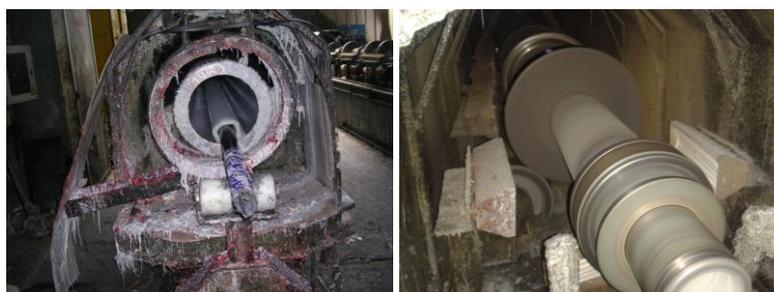
Figura 128 – Stampo centrifuga termo – regolabile
