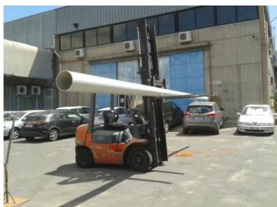
Figura 139 - Prova di caduta da 2 m sull'asfalto
