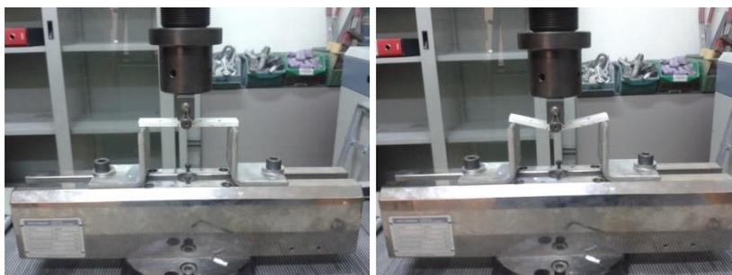
Figura 97 - Prova di flessione UNI 7219
