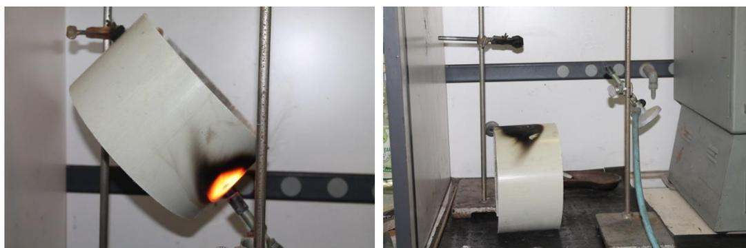
**Figura 120 - Prova di autoestinguenza**
