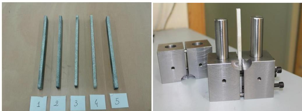
Figura 90 - dimensioni provino a compressione
