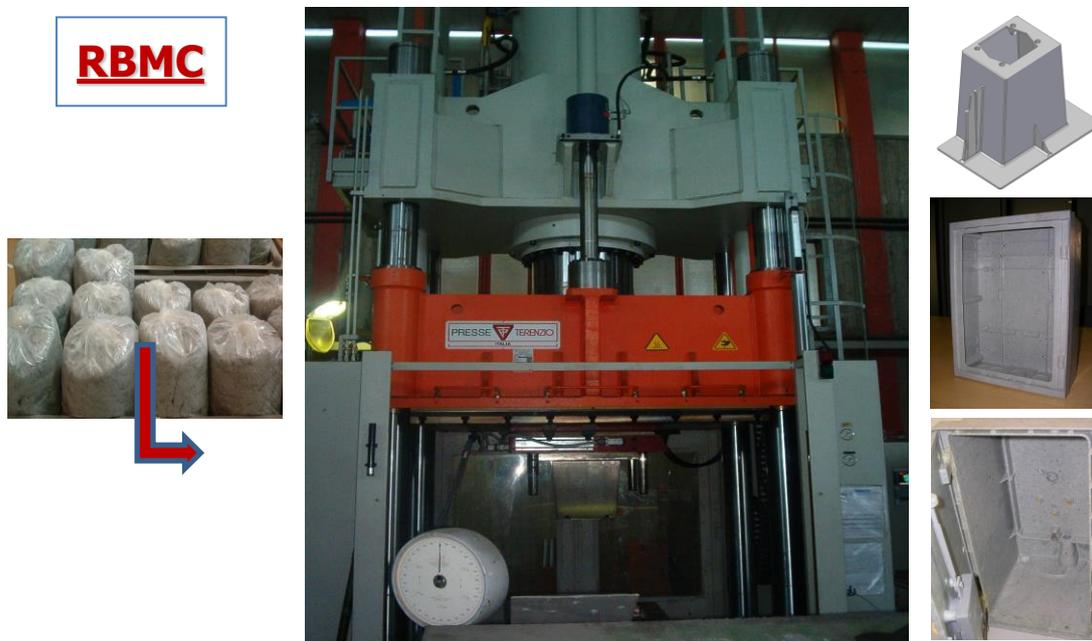
Figura 229 - Processo di produzione di componenti in RBMC.
