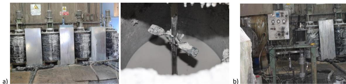
Figura 133 – a) Vasche di miscelazione della resina; b) impostazione catalizzatore
