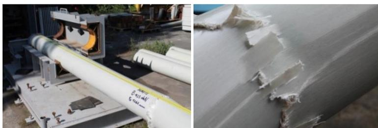
Figura 18 - Rottura per delaminazione
