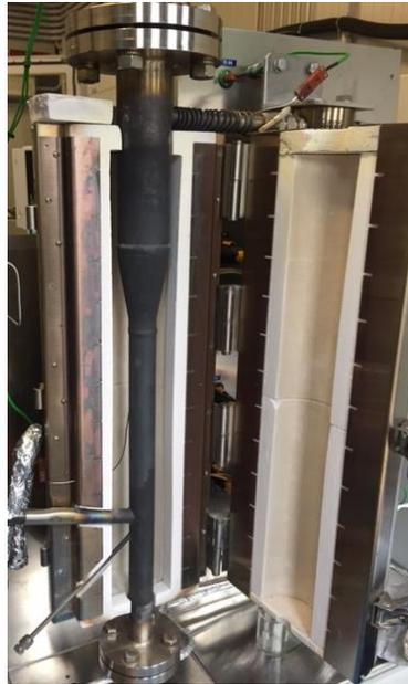
Figura 5.1. - Reattore di gassificazione a letto fluido
