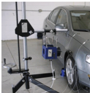
Figura 16: Analisi Modale su autoveicolo.
