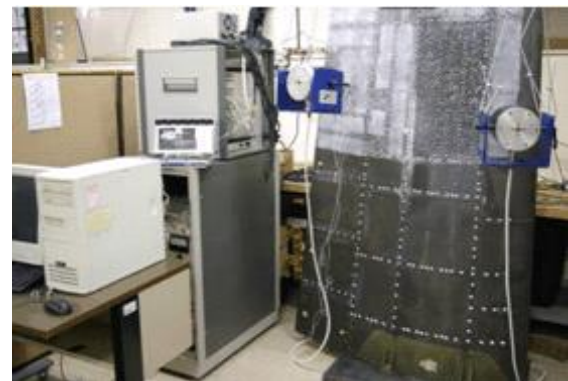
Figura 17: Analisi Modale su parti di aereo.
