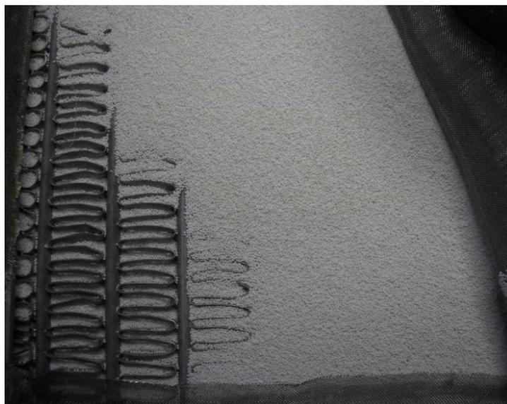
Figura 15: Deposizione dei granuli di zeolite su uno scambiatore di calore alettato.
