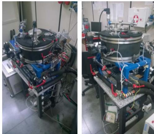
Figura 104: Impianto per la misura della cinetica di ad/desorbimento.
