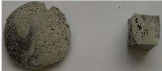
Figura 125: Schiuma composita con lo 0,25% di nanotubi di carbonio.
