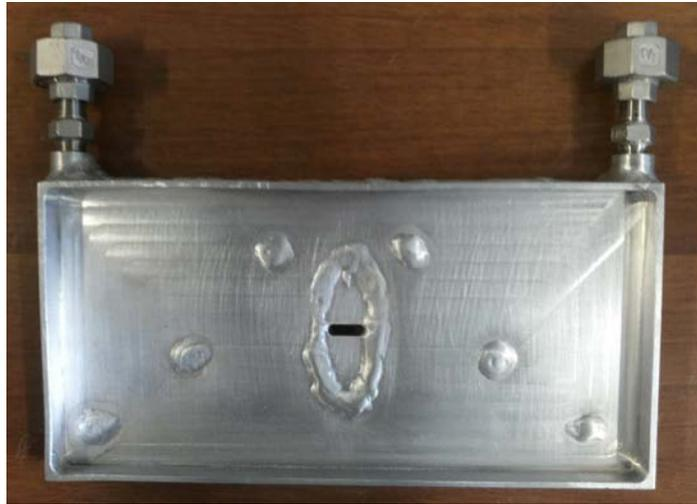
Figura 87: Scambiatore di calore a piastre.
