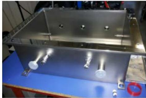
**Figura 85: Particolare della camera da vuoto.**
