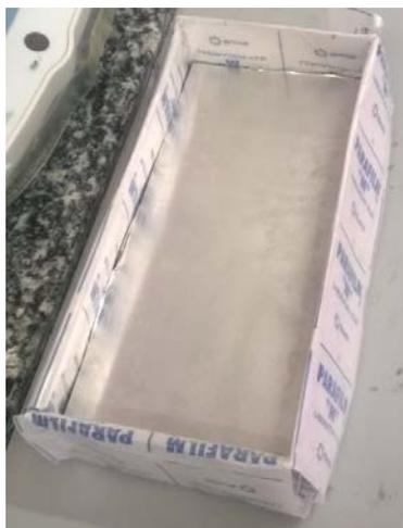
**Figura 111: Modulo semi-removibile per lo schiumaggio.**
