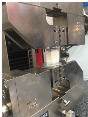
Figura 63: Prova di compressione.
