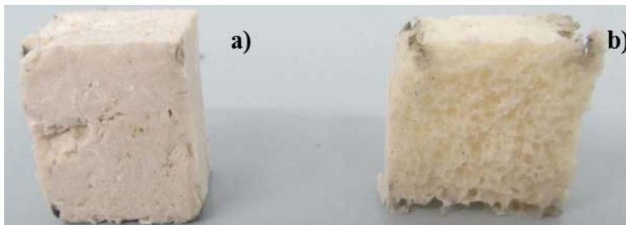
Figura 26: Schiume composite al 70% (a) e 20% (b) di zeolite.
