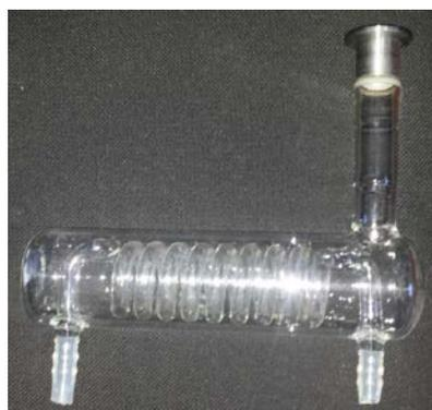
**Figura 86: Scambiatore di calore in vetro.**
