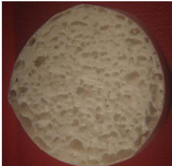
Figura 32: Sezione trasversale di una schiuma al 50% di zeolite.
