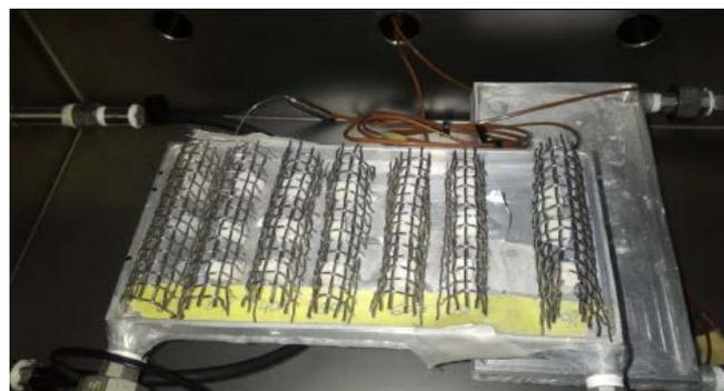
**Figura 92: Schiume di zeolite prima della fase di invecchiamento.**
