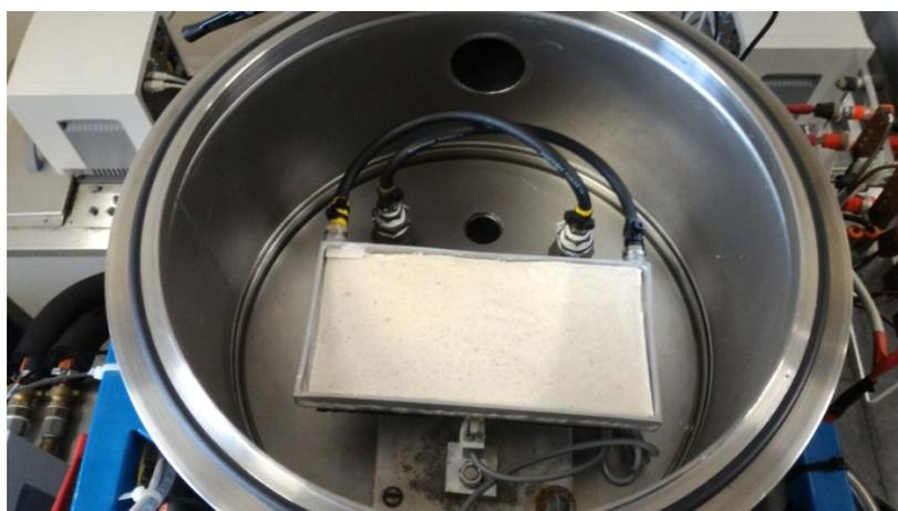
**Figura 113: Posizionamento della schiuma composita all'interno dell'impianto.**
