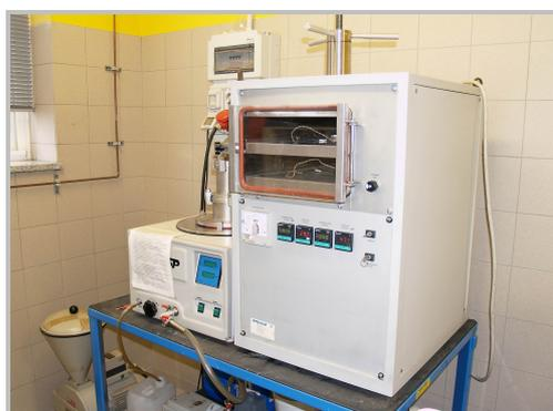
**Fig.24.** Liofilizzatore utilizzato per il trattamento dei campioni
