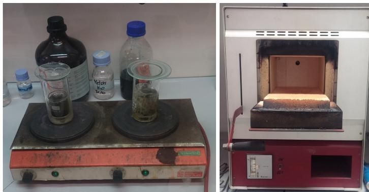
Fig.25. Trattamento delle ceneri con HCL 2N; Muffola utilizzata per combustione del campione
