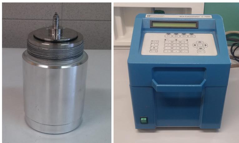
**Fig.26.** Cilindro utilizzato per la combustione in atmosfera satura di O<sub>2</sub> ; bomba calorimetrica adiabatica (IKA7000, Germany)
