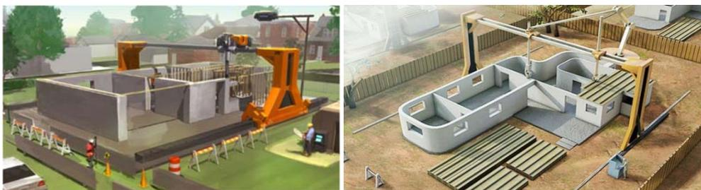
**Figura 6.1** Illustrazioni dell'utilizzo della stampa 3D nel settore edilizio per lo stampaggio di elementi di grandi dimensioni
