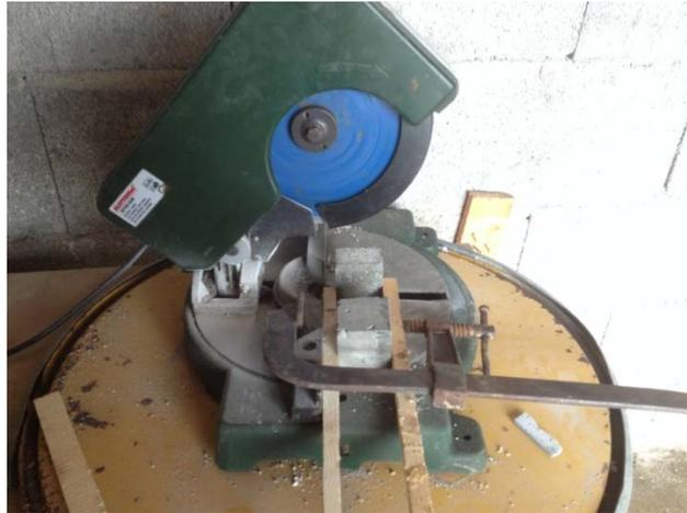
**Figura 4.51** Sega circolare munita di disco diamantato di spessore sottile impiegata per il taglio dei provini cubici di calcestruzzo schiumato bloccati e serrati mediante l'utilizzo di due listelli in legno e di uno strettoio in acciaio
