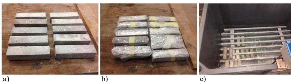
**Figura 4.16** Provini prismatici di calcestruzzo schiumato estrudibile in diverse condizioni di stagionatura: in aria a); in cellophane b); in acqua c)
