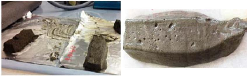
**Figura 4.2** Estrusi di calcestruzzo schiumato ultra-leggero con insufficiente stabilità dimensionale
