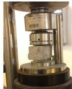
**Figura 4.24** Fotografie del telaio di prova CONTROLS 65-L1301/FR utilizzato per i test di flessione su tre punti (colonna di sinistra) e per i test di compressione (colonna di destra)
