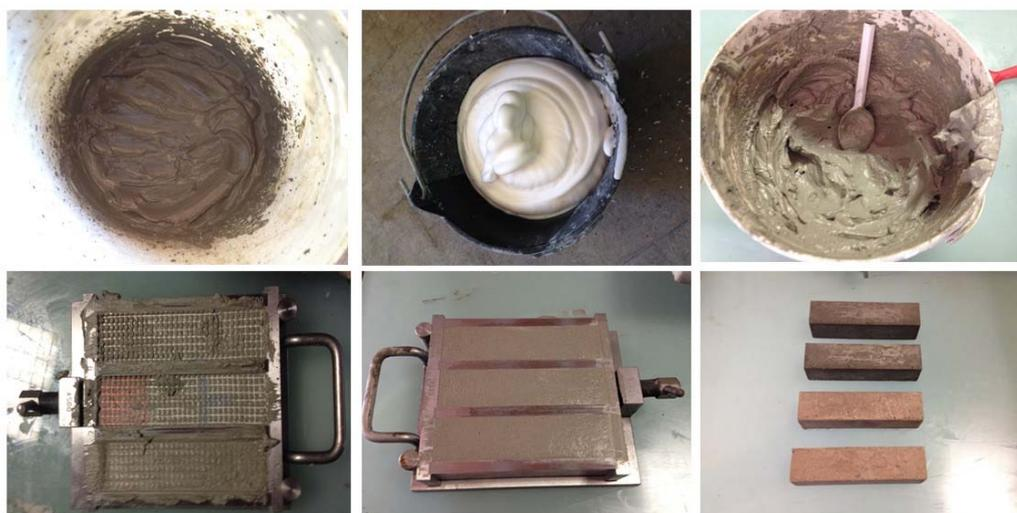
**Figura 4.23** Fotografie in ordine cronologico a partire dall'alto a sinistra fino in basso a destra delle fasi di preparazione dei provini prismatici di calcestruzzo schiumato estrudibile
