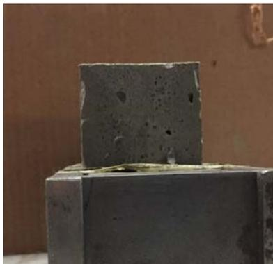
**Figura 5.62** Tenuta dimensionale dell'estruso in calcestruzzo schiumato innovativo con densità secca target pari ad  $400 \text{ kg/m}^3$  a 5 minuti dal termine della fase di miscelazione
