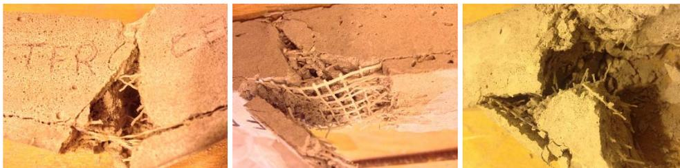
**Figura 4.38** Particolari di un provino prismatico di calcestruzzo schiumato estrudibile con la simultanea presenza di fibre polimeriche e griglia bi-direzionale maturato in cellophane dopo l'esecuzione della prova a flessione su tre punti
