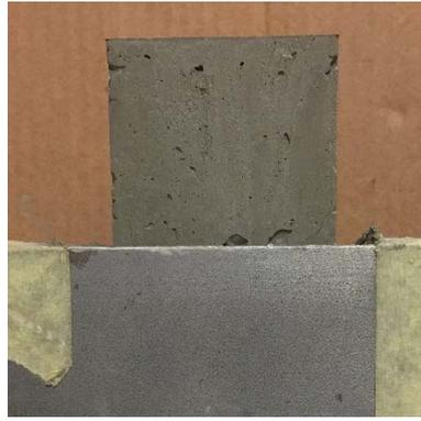
**Figura 5.88** Tenuta dimensionale dell'estruso in calcestruzzo schiumato innovativo con densità secca target pari ad  $800 \text{ kg/m}^3$  a 5 minuti dal termine della fase di miscelazione
