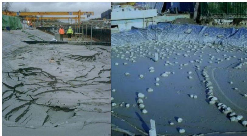
**Figura 3.8** Esempi di instabilità di calcestruzzi schiumati ultra-leggeri [46]
