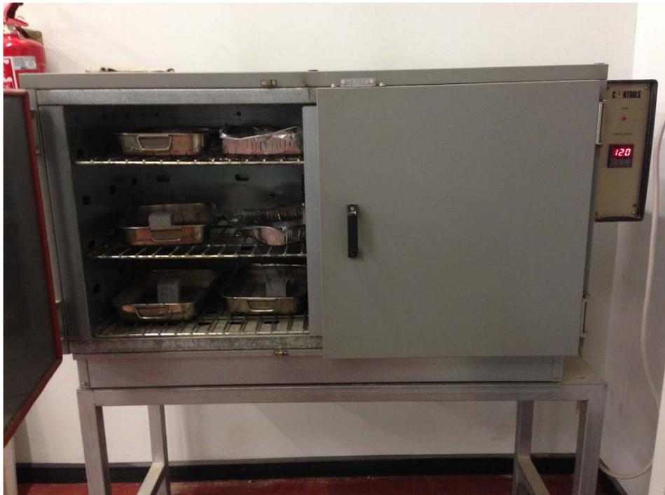
**Figura 3.13** Stufa utilizzata per l'essiccazione dei provini di calcestruzzo schiumato così da valutarne la densità secca
