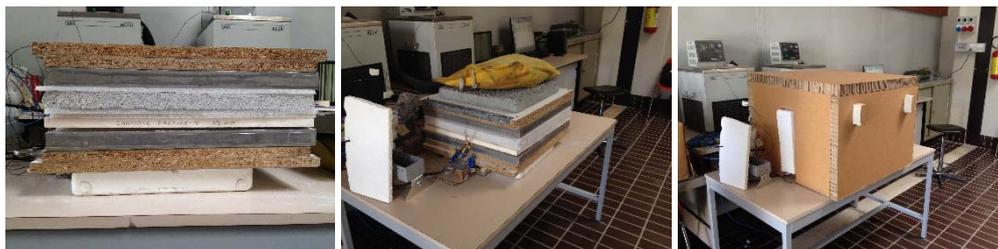
**Figura 4.47** Metodo del termoflussimetro per la determinazione del coefficiente di conducibilità termica
