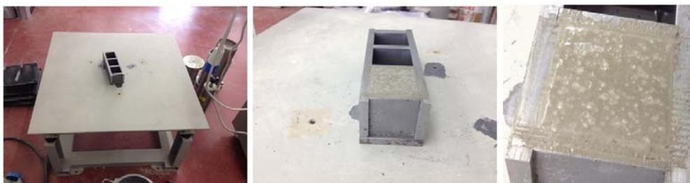
**Figura 3.14** Confezionamento dei provini per la valutazione della densità della matrice cementizia non alleggerita con schiuma  $\gamma_{ss}$
