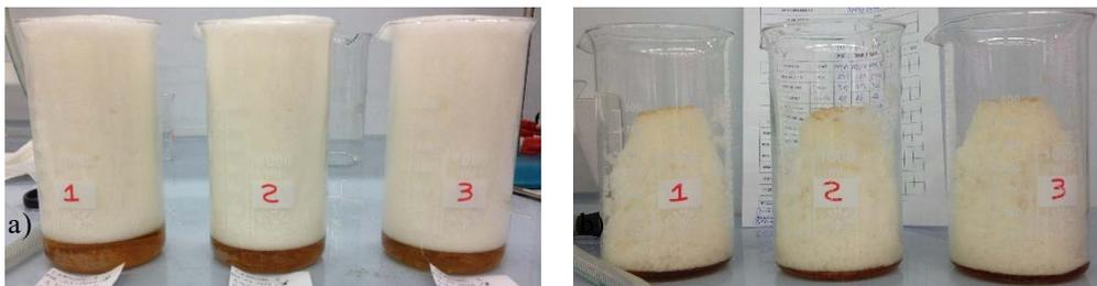
**Figura 2.22** Prelievo di schiuma realizzata con tensioattivo proteico Foamin C<sup>®</sup> costituito da tre diversi campioni: dopo 15 minuti dalla produzione della schiuma a); dopo diverse ore b)
