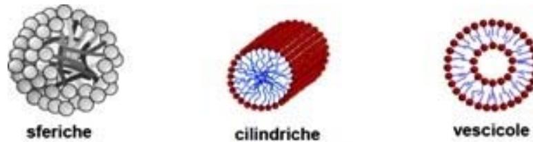
**Figura 2.8** Possibili configurazioni delle micelle.
