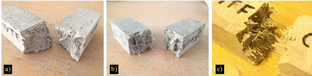
**Figura 4.25** Provini prismatici portati a rottura a flessione con tre differenti contenuti di fibre inglobate nella matrice cementizia: 0,7% a); 2,0% b); 5,0% c)
