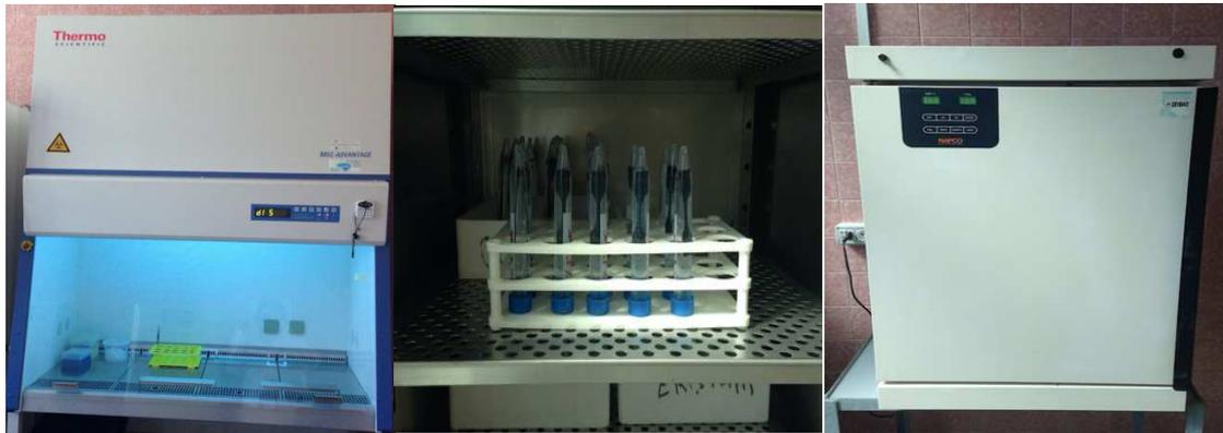
Figura 5.14 - Fotografia della Cappa sterile (a); provette in cui sono stati immersi i campioni (b); sistema Termostato (c).
