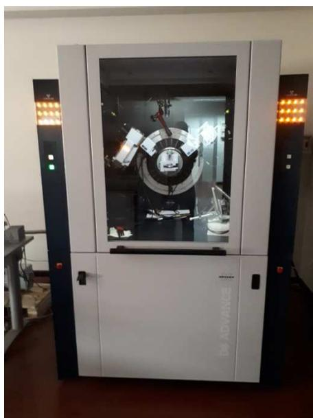
Figura 2.16 - Diffrattometro Bruker D8 Advance.
