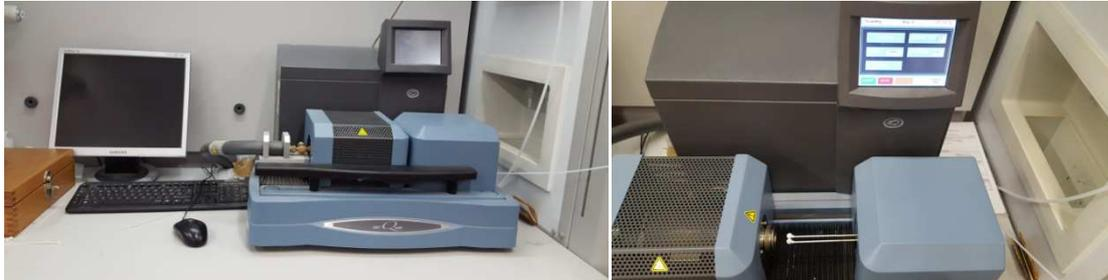
Figura 2.12 - Analizzatore termogravimetrico, TA Instruments, *SDTQ600*.
