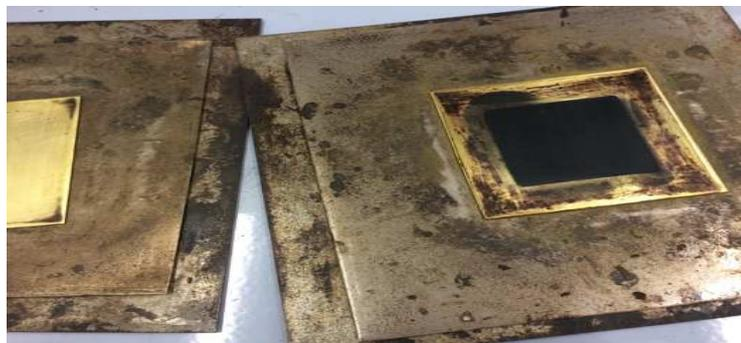
Figura 5.5 - Stampo utilizzato in pressa e campione ottenuto.
