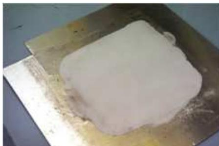
Figura 3.18 - Lastrina di UHMWPE ottenuta per termoformatura.
