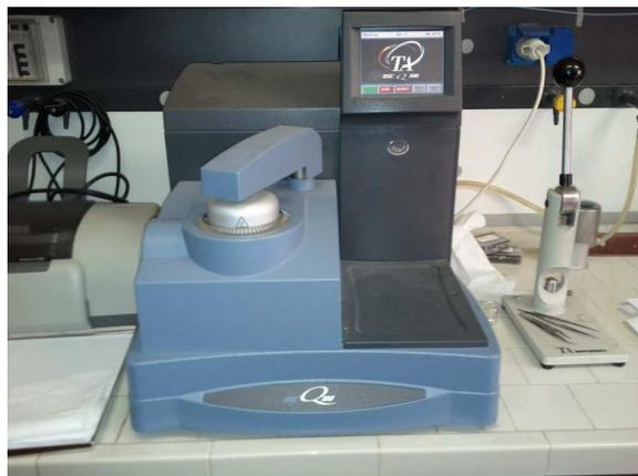
Figura 2.11 - Calorimetro a Scansione Differenziale della TA Instruments *Q100 V8.1 Build 261*.
