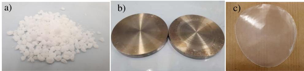
Figura 4.3 – Pellets di LLDPE (a); immagine dello stampo in acciaio (b) e film di LLDPE ottenuto (c).
