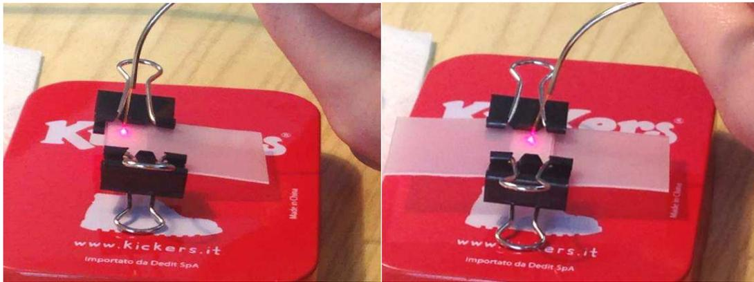
Figura 3.22 - Immagine fotografica degli step di saldatura laser di un giunto double lap [100].
