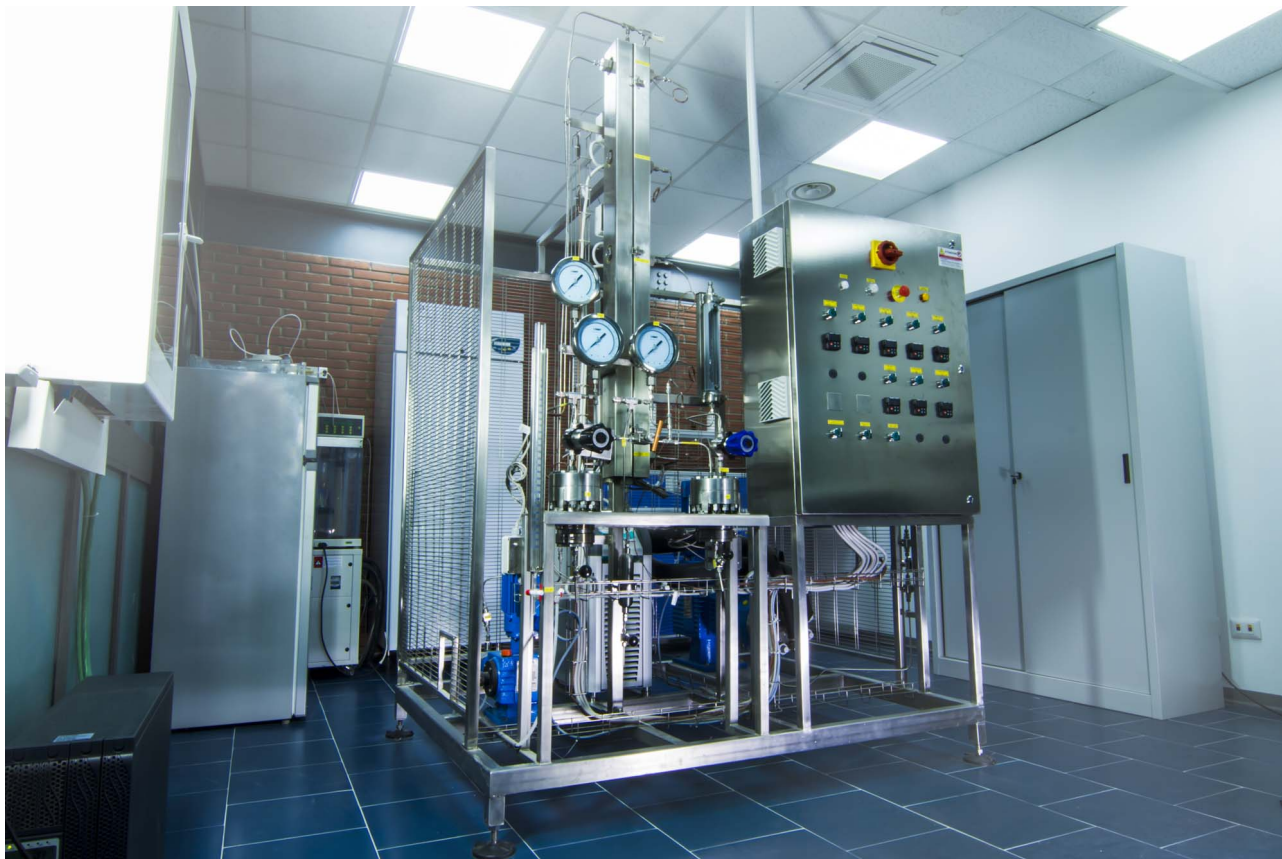
Figura 14 Impianto da laboratorio per l'estrazione con CO 2 supercritica
