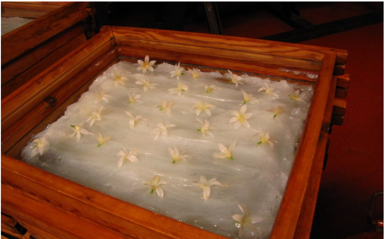
Figura 12 Telai di vetro utilizzati per l'enfleurage
