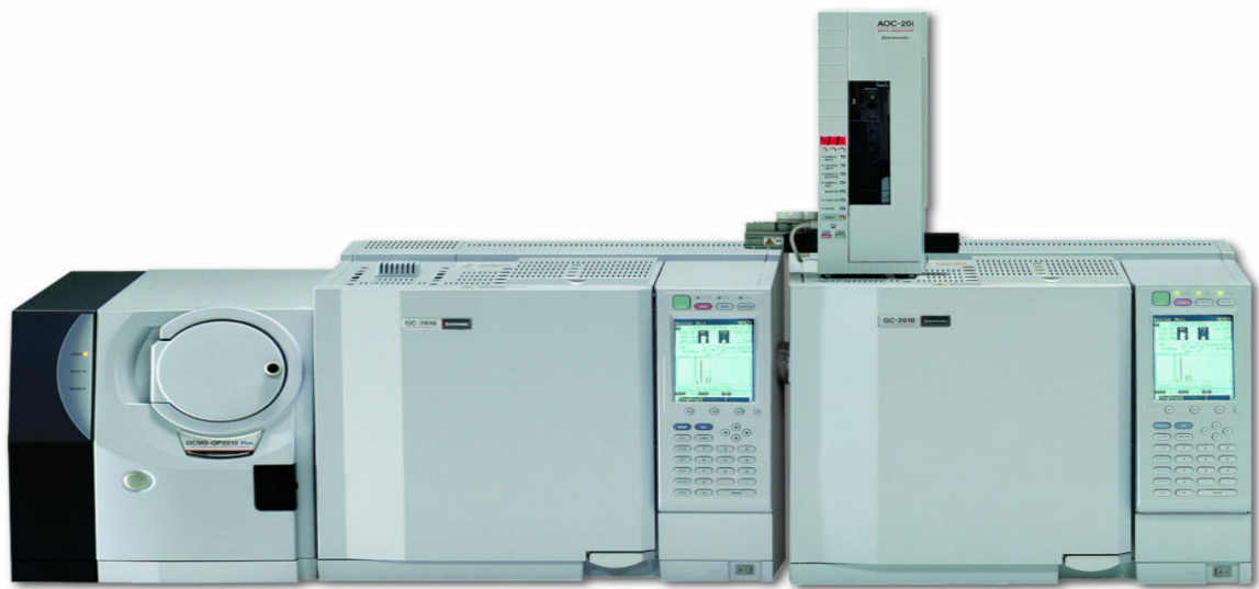
Figura 24 Sistema MDGC heart-cutting accoppiato a uno spettrometro di massa
