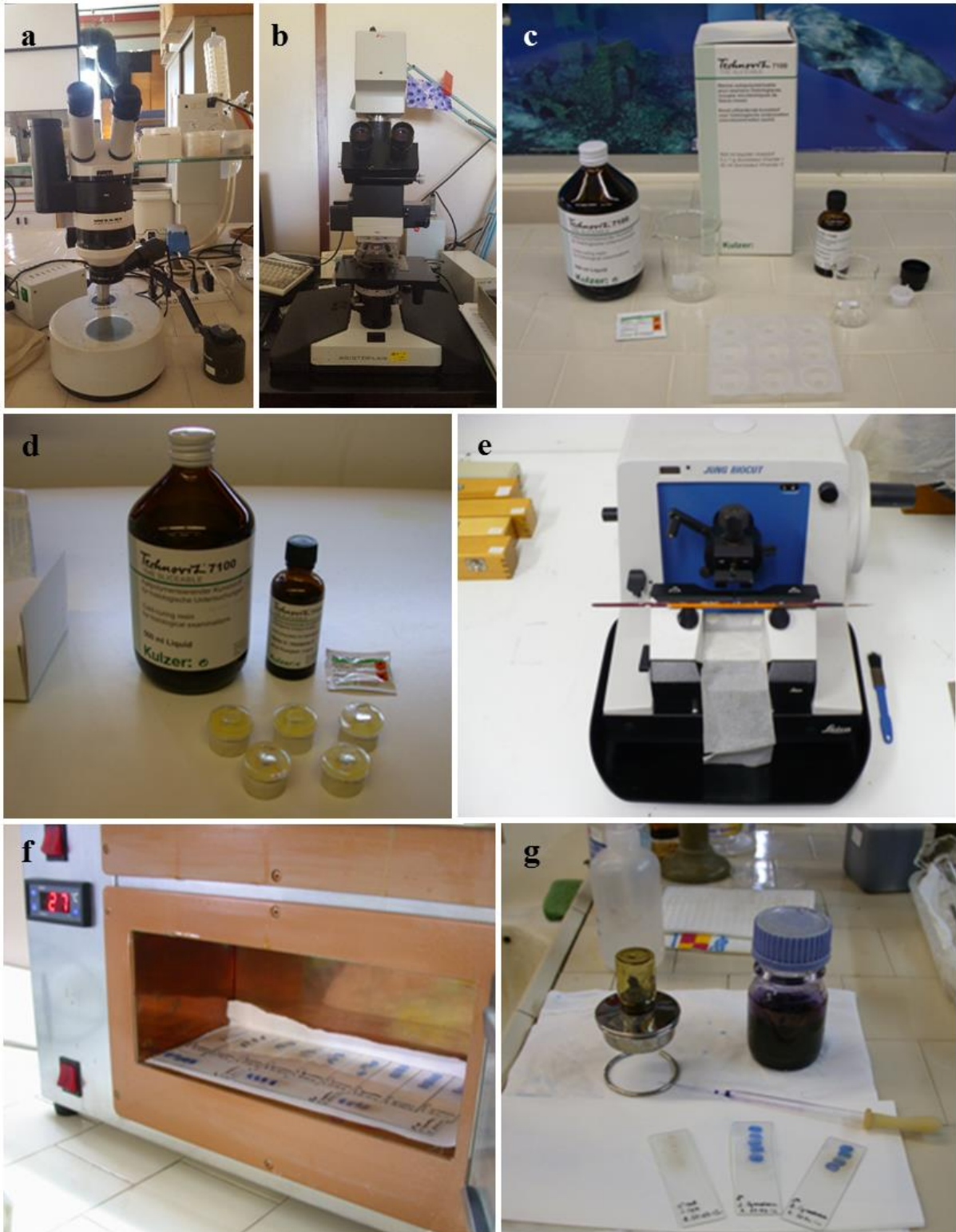
Fig. 1 a-g. (a) Microscopio da dissezione (Leica Wild M5A); (b) microscopio Ottico Aristoplan (Leica) attrezzato con una macchina fotografica Leica DF500; (c) componenti della resina Technovit 7100; (d) apici radicali di fanerogame marine incluse in resina; (e) microtomo rotativo; (f) essiccamento delle sezioni in stufa; (g) colorazione delle sezioni con Blu di Cresile brillante.
