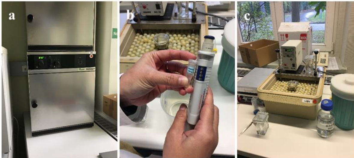
Fig. 18a-c. Pretrattamento dei vetrini. (a) Incubazione apici radicali e caulinari in camera umida a 37^{\circ}\text{C} ; (b, c) Trattamento dei vetrini con la soluzione di pepsina a bagnomaria a 37^{\circ}\text{C} .
