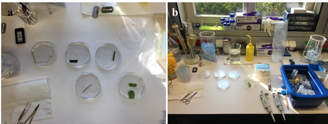
Fig. 29a-b. Preparazione sospensioni di nuclei. (a) Tessuti fogliari di Cymodocea nodosa , Posidonia oceanica e Zostera noltei e di ciascuno standard di riferimento posti al centro di una capsula di Petri in plastica; (b) piano di lavoro con la strumentazione e le soluzioni utili alla preparazione della sospensione.
