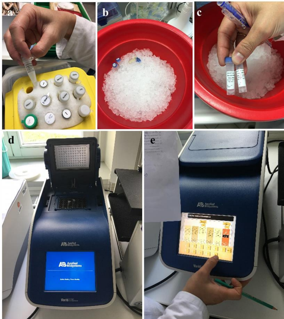
Fig. 14a-e. Preparazione delle sonde ribosomiali e telomeriche. (a) DreamTaq DNA Polymerase™; (b) preparazione dei prodotti utilizzati su ghiaccio; (c) primer telomeric (Hu_telomere F e R, Eurofins MWG Operon); (d) Veriti™ 96-Well Thermal Cycler (Applied Biosystems™); (e) impostazione programmi per i diversi step.
