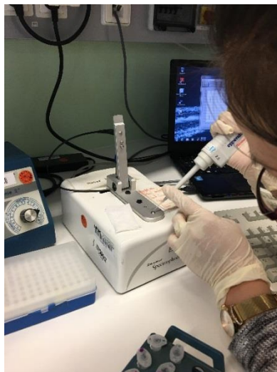
Fig. 11. Spettrofotometro NanoDrop™ 2000/2000c (Thermo Scientific™). Inserimento di 1µl di campione nell'apposito recettore per analizzare il campione.
