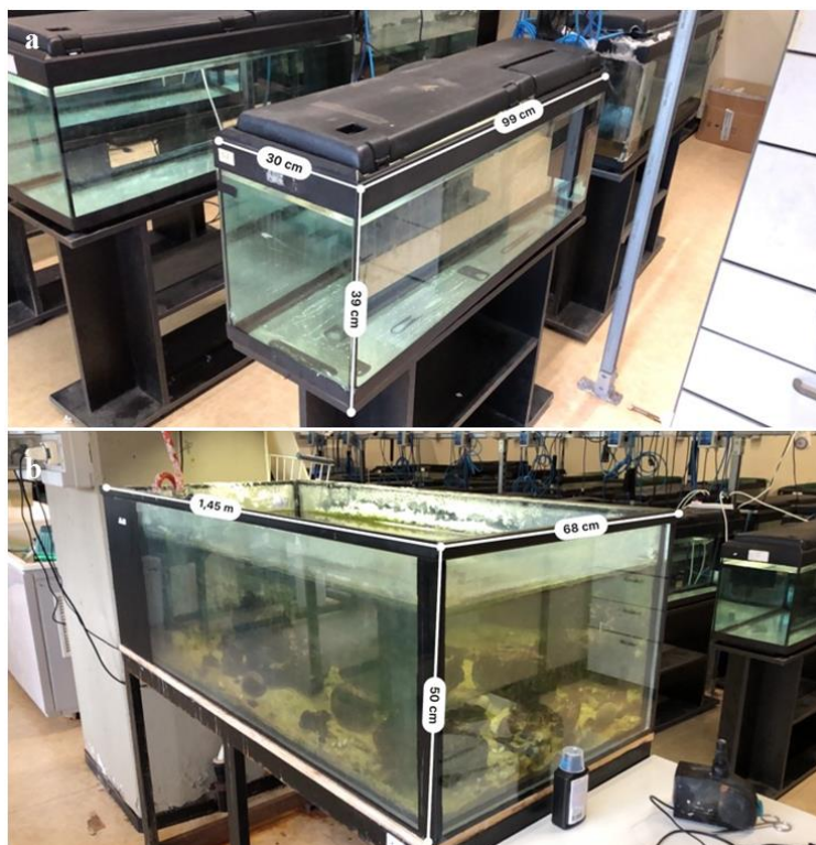
Fig. 3a-b. Tipologie di acquari allestiti presso il laboratorio del Centro di Ittiopatologia Sperimentale della Sicilia (CISS) del Dipartimento di Scienze Veterinarie. (a) esempio di acquario da 120 l; (b) acquario di 400 l.
