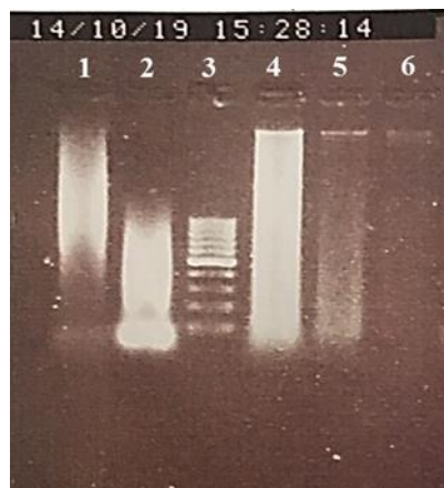
Fig. 79. Analisi corsa elettroforetica su gel di agarosio. Note: 1= regioni di telomeri umani a concentrazione 0.1μl (hutelo_0.1); 2= regioni di telomeri umani a concentrazione 1μl (hutelo_0.1); 3= gene rules 100bp; 4= DNA isolato di Zostera_noltei_1 ; 5= DNA isolato di Cymodocea_nodosa_1 ; 6= DNA isolato di Posidonia_oceanica_1 .
