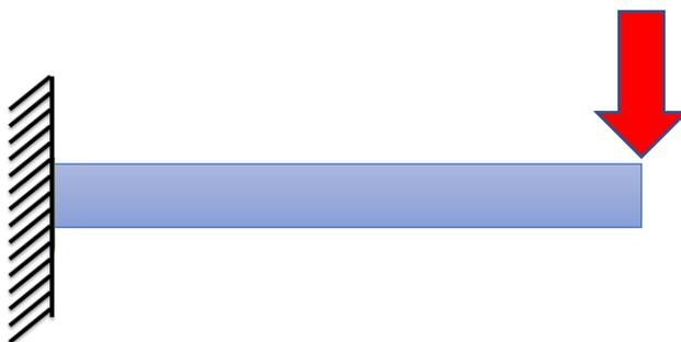
*Figura 44 – sistema equivalente trave monolitica*
