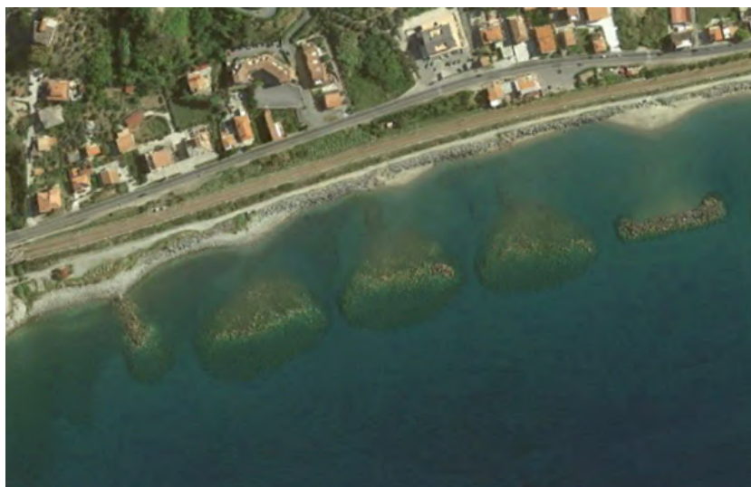
Figura 5.20: Dettaglio di Marina di Belvedere: la linea di costa è individuata dalle scogliere radenti che proteggono la linea ferroviaria (Fonte: Google Earth).
