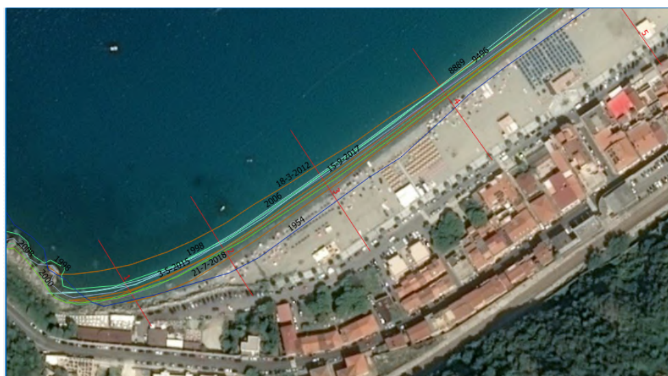
Figura 2.8: Transetti e linee di riva nella pocket beach di Scilla (RC) (Barillà et al., 2020a).
