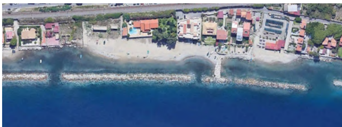
Figura 5.21: Dettaglio di Porticello: la linea di costa è individuata dalle scogliere radenti che proteggono le case a tergo delle barriere (Fonte: Google Earth).
