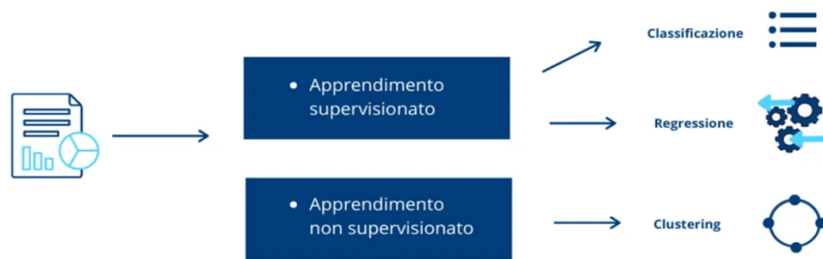
FIG. N. 3: Unsupervised learning : il sistema dovrà identificare negli input somministratigli una struttura logica senza che questa sia stata preventivamente etichettata per poi raggruppare i dati sulla base di caratteristiche simili. Nell’immagine, la ricognizione di dati effettuata attraverso la modalità di “ clustering ” (alternativa alla “ dimensionality reduction ”).
