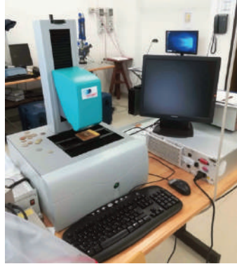
Figura 8: Micro-profilometro laser Optimet MiniConoScan 3000 con ConoProbe 1000 all'interno del laboratorio Ar3Digilab dell'IPCF-CNR di Messina.
